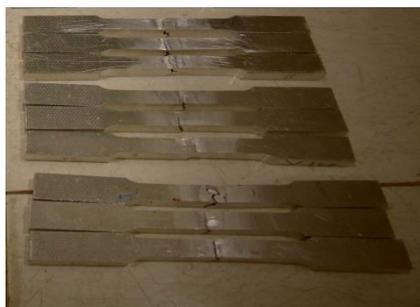
Gambar 3.4 Spesimen sudah diuji tarik
