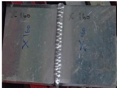
Gambar 3.3 Proses pengelasan MIG
